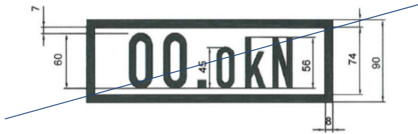
Fig. 4 : Inscription de la masse freinée et de l'effort de retenue en kN pour véhicules munis d'un frein à vis
